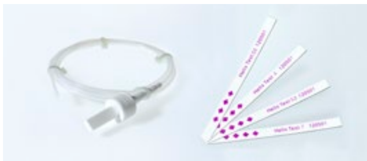
CYKELSPECIFIKA HELIXTESTER KALIBRERADE FÖR SPECIFIKA ÅNGSTERILISATIONS CYKLER PÅ 3,5, 4, 5,3 OCH 7 MINUTER VID 134 °C.
